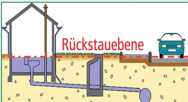
Alle Entwässerungsgegenstände unterhalb der Rückstauenebene sind gemäß technischer Norm DIN EN 12056 gegen Rückstau zu sichern.
