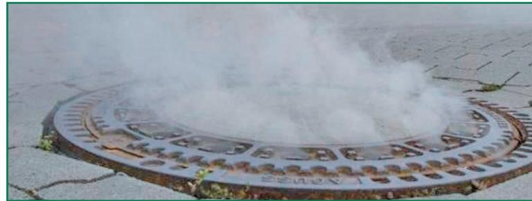
Hierfür wird ein Abschnitt des Kanals (Regen- oder Schmutzwasser) zwischen zwei Schächten (ca. 150 m) kurzfristig abgesperrt und mit einem geruchlosen, umwelt- und gesundheitsverträglichen Signalnebel gefüllt. Tritt bei der Untersuchung der Schmutzwasserleitung Nebel an Dachrinnen oder Hofeinfäulen aus, liegt augenscheinlich ein Fehlschluss vor.
