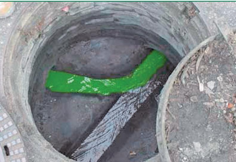
Hierfür wird in die Schmutzwasserabflüsse im Haus der nicht umweltgefährdende Farbstoff Uranin gegeben. Tritt gefärbtes Wasser in den Regenwasserabfluss ein, sind die Anschlüsse falsch verbunden worden. Der Farbttest kann auch umgekehrt zur Überprüfung von Fehlschlüssen von Regenwasserleitungen an Schmutzwasserleitungen erfolgen.
